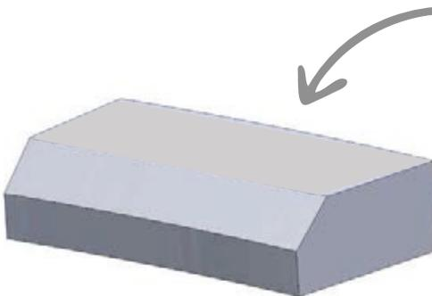
Quando o corte ou chanfro estiver posicionado do **lado interno** do anel, orienta-se montar voltado para cima em relação ao pistão.
