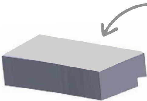
Quando o corte ou chanfro estiver posicionado do **lado externo** do anel, orienta-se montar voltado para baixo em relação ao pistão.
