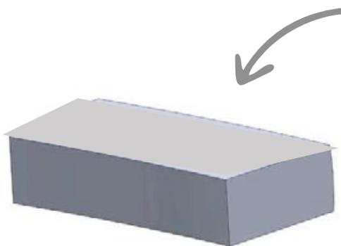
Quando não tiver corte ou chanfro em **nenhum dos lados**, e não for anel trapezoidal orienta-se montar em qualquer posição em relação ao pistão.
